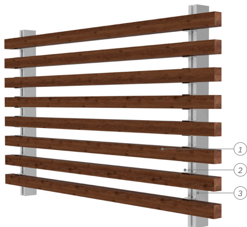
Infografía CL W 35 Thermopine ① Lama madera de pino termotratado ② Pinza de acero inoxidable ③ Montante de aluminio extruido
